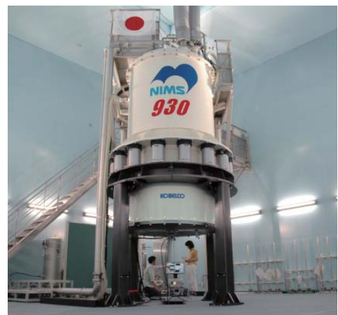
図 1. 従来技術では葉緑素の Mg - NMR 信号を観測することは不可能だった。NIMS が独自技術で開発した強磁場 NMR 装置により世界で初めて観測に成功した。磁場強度 21.8T (=930MHz) は固体 NMR 装置としては世界最高。
